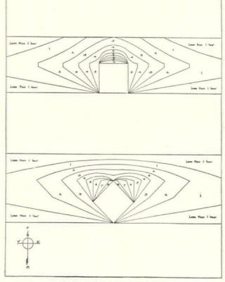
FIG. 2 .- SHADOW CURVES OF A CUBE.
